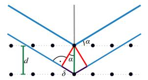
Die Maxima in dem gemessenen Spektrum entstehen, wenn die Maxima der (an verschiedenen Ebenen) reflektierten Lichtwellen bereinander liegen. Dies ist z.B. bei  $\alpha \approx 7.5^{\circ}$ . Also muss hier der Gangunterschied  $2\delta$  genau der Wellenlinge  $\lambda$  entsprechen:
