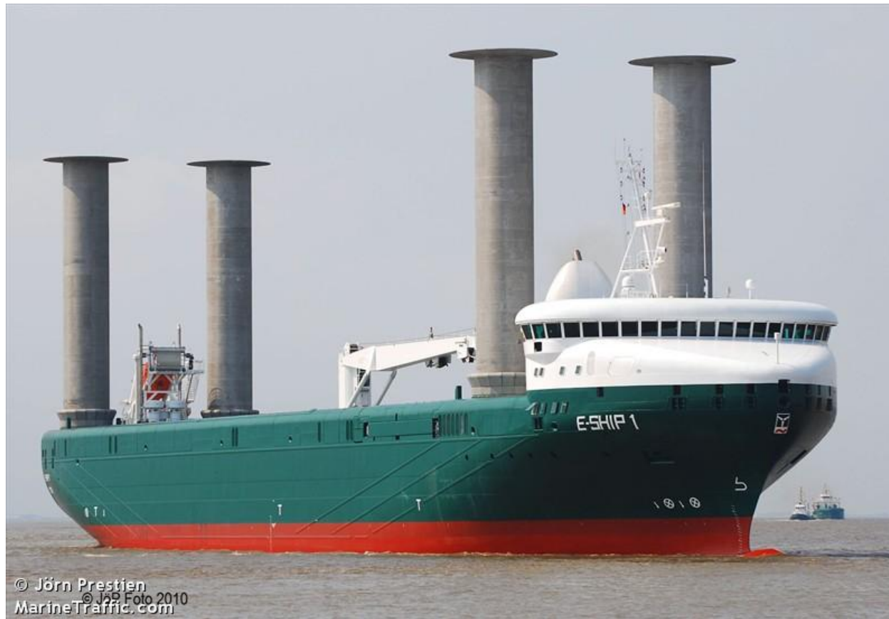
E-Ship 1: Antrieb mit Diesel und Flettner-Rotor
