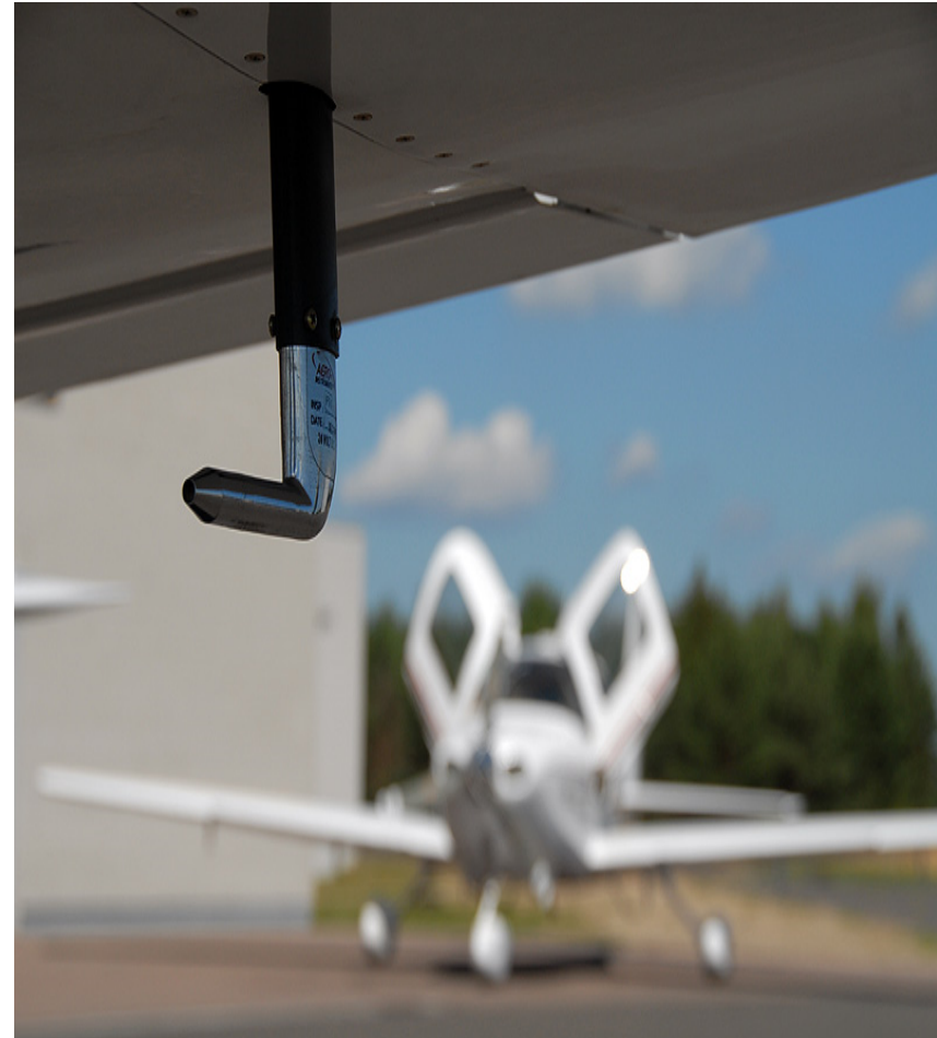
Pitot-Rohr von Kleinflugzeug
