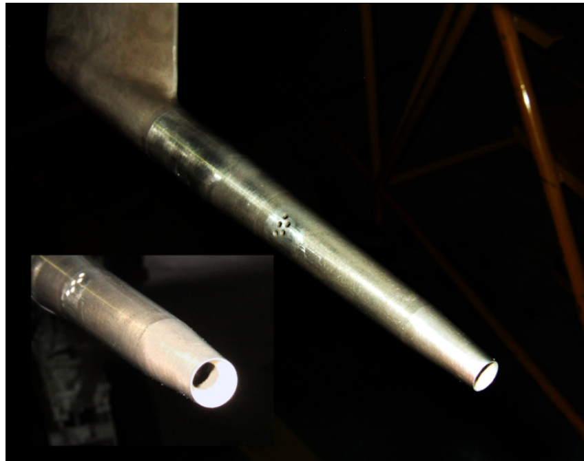
Prandtl'sches Rohr von F/A 18
