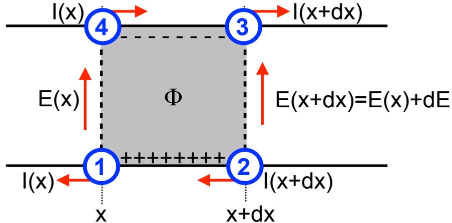
Induktionsspannung:  $\oint_{1-2-3-4-1} \vec{E} d\vec{s} = - \frac{\partial \Phi}{\partial t} = - L^* dx \frac{\partial I}{\partial t}$
