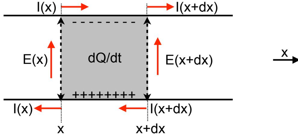
1.) Ladungsänderung im Leiterstück:  $x \dots x+dx$ :  $d^2Q = \{ I(x) - I(x+dx) \} dt = -\frac{\partial I}{\partial x} dx dt$
