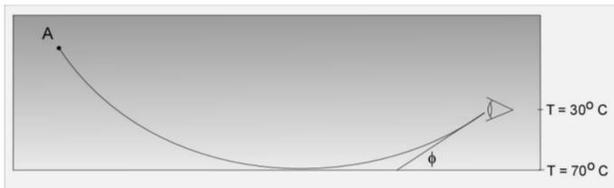
Die Temperaturabhängigkeit des Brechungsindex von Luft sei gegeben durch:  $n(T) = 1.000291 - 10^{-6} \cdot T$  ( $^{\circ}\text{C}^{-1}$ ). An einem heissen Sommertag sei die Strassentemperatur  $70^{\circ}\text{C}$  und die Temperatur am Punkt des Beobachters  $30^{\circ}\text{C}$ . Ein Lichtstrahl der von Punkt  $A$  ausgeht nehme den in der Abbildung beschriebenen Verlauf (dieses Phänomen wird auch als Fata Morgana bezeichnet).
