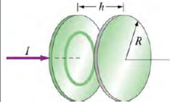
**S** gegen Zentrum des Kondensators: Energie fließt in elektrisches Feld! ( $S=0$  für  $C=0$  oder  $dE/dt=0$ !)
