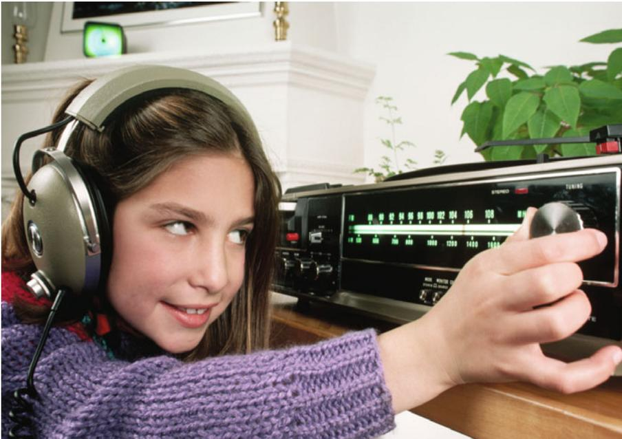
Die junge Radiohörerin stellt ihren Lieblingssender ein. Durch das Drehen am Abstimmknopf ändert sich die Resonanzfrequenz eines elektrischen Schwingkreises im Tuner, und nur das Signal des ausgewählten Senders wird verstärkt. (© Roger Ressmeyer/Corbis.)
