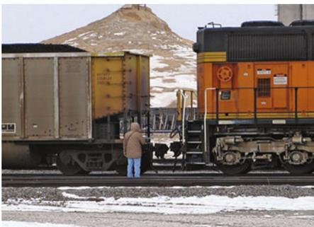
Die Lokomotive stößt den Waggon an, wodurch die automatische Kupplung die beiden Stoßpartner verbindet – ein Beispiel für einen vollständig inelastischen Stoß. (© Mit freundlicher Genehmigung von Dick Tinder.)
