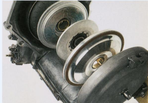
Die Kupplung in einem LKW-Getriebe trennt beim Auskuppeln die vom Motor angetriebene Schwungscheibe (hinten) vom Getriebe. Die Kupplungsscheibe (Mitte) wird beim eingekuppelten Fahren von der Druckplatte des Automaten (vorn) auf die Schwungscheibe gepresst. Dabei wird die kinetische Energie der Schwungscheibe auf die Antriebsachse übertragen. (© Dick Luria/Science Source/Photo Researchers.)
