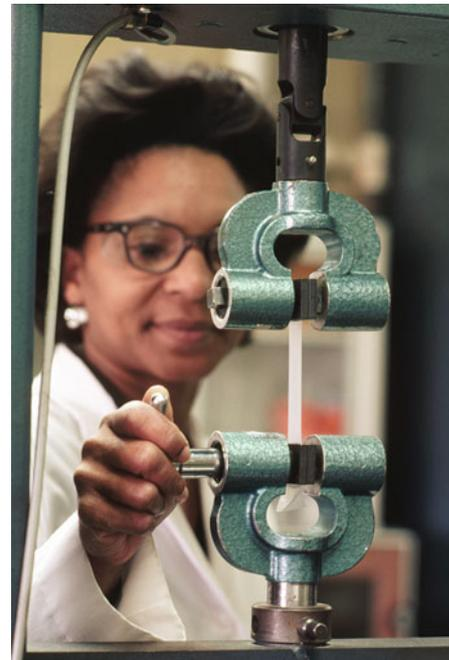
Um seine Zugfestigkeit zu messen, wird ein Stab gedehnt, bis er zerbricht. (© Vin- ce Streato/Corbis.)
