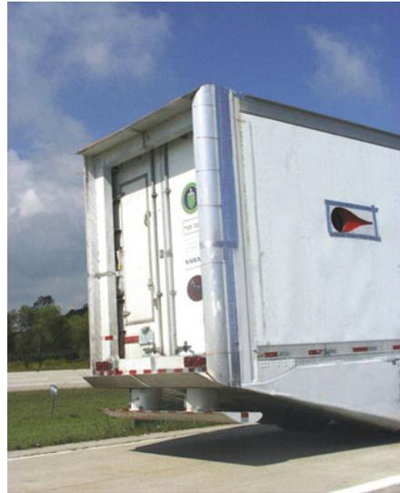
Selbst bei den relativ niedrigen Geschwindigkeiten eines Lastkraftwagens spielt der Luftwiderstand eine Rolle. Bei diesem Prototyp wird der Luftwiderstand durch die Luftströmung an den speziell abgerundeten Kanten des Anhängers reduziert. (Mit freundlicher Genehmigung des Georgia Institute of Technology.)
