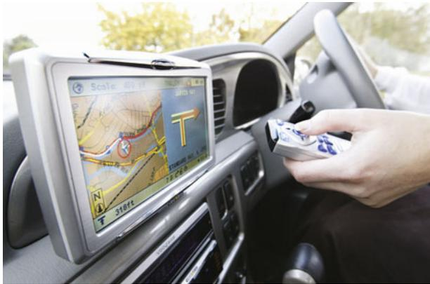
Das Fahrzeugnavigationssystem erhält Informationen von GPS-Satelliten und berechnet daraus Ort und Geschwindigkeit des Autos. Unter bestimmten Voraussetzungen ermittelt es mittels *Koppelnavigation* den Verschiebungsvektor. (© Andrew Fox/Corbis.)
