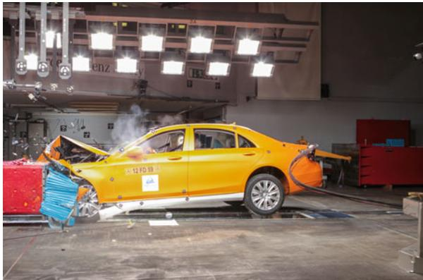
Abbildung 6.10 Dummy beim Crashtest. (© Daimler AG.)
