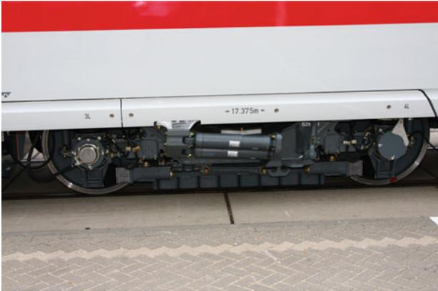
Wirbelstrombremse an einem Zugwaggon. (© S. Terfloth)
