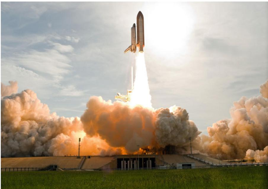
Die Schubkraft, die eine Rakete abheben lässt, ergibt sich aus der Brennrate und der Geschwindigkeit, mit der die Verbrennungsgase ausgestoßen werden. Dabei verliert die Rakete durch die Verbrennung des Treibstoffs ständig an Masse. (© NASA.)
