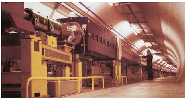
Blick in den Tunnel des Proton-Antiproton-Beschleunigerings des CERN. Protonen und Antiprotonen bewegen sich in entgegengesetzter Richtung durch den Ring; zur Führung der Teilchen können ein und dieselben Ablenk- und Fokussiermagnete verwendet werden. Die Magnete befinden sich in den großen, rechteckigen Kästen, die im Bild zu sehen sind. (© CERN.)
