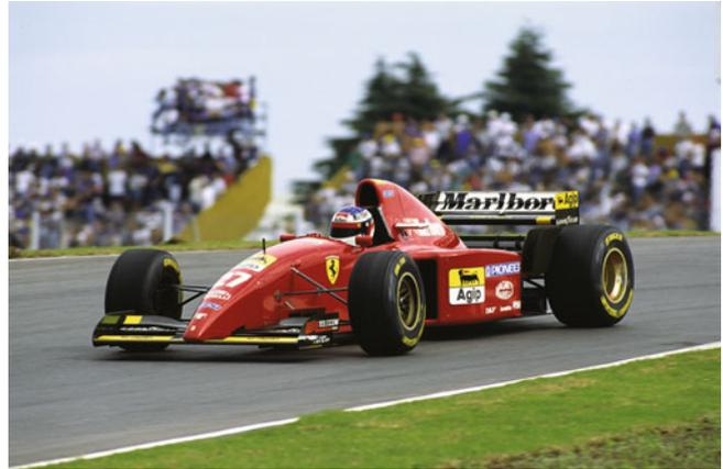
Die Luftströmung über dem Spoiler des Formel-1-Rennwagens erzeugt einen größeren Druck auf den Spoiler. Damit erhöht sich das effektive Gewicht des Fahrzeugs und somit die Bodenhaftung bei hohen Geschwindigkeiten. Zusätzlich führt der Venturi-Effekt zu einer Druckreduzierung auf der Unterseite des Fahrzeugs. Die damit verbundene abwärts gerichtete Kraft wird als Bodeneffekt bezeichnet. (© Schlegelmilch/Corbis.)
