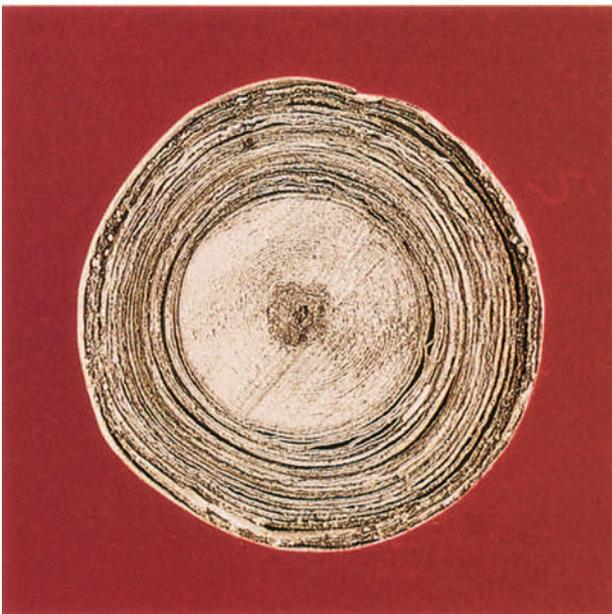
Schnittansicht eines Folienkondensators. (© Bruce Iverson.)
