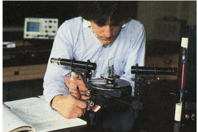
**Abbildung 30.12** Ein Spektroskop, wie es in der Ausbildung verwendet wird. Das von einem Kollimatorspalt nahe der Lichtquelle durchgelassene Lichtbündel wird mithilfe einer Linse zu parallelen Lichtstrahlen gebündelt, die auf das Gitter fallen. Das von diesem gebeugte Licht wird mit einem Teleskop betrachtet, dessen Drehwinkel an der Halterung genau abgelesen werden kann. (© Clarence Bennett/Oakland University, Rochester, Michigan.)
