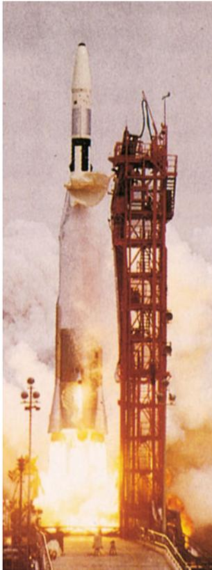
**Abbildung 7.45** Die Schubkraft, die eine Rakete abheben lässt, ergibt sich aus der Brennrate und der Geschwindigkeit, mit der die Verbrennungsgase aus dem Motor ausgestoßen werden. (© NASA/Superstock.)
