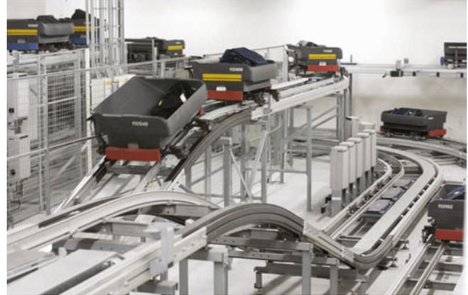
Die Geschwindigkeiten der Wägelchen, die das Gepäck zwischen den Terminals am Heathrow International Airport transportieren, werden durch Linearinduktionsmotoren gesteuert. (© Vanderlande Industries.)
