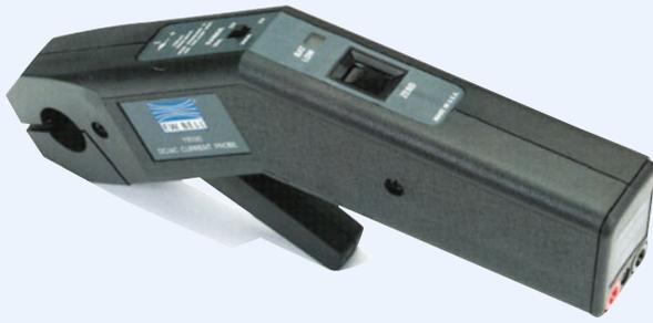
Mit diesem Prüfgerät kann man elektrische Ströme messen. Die Backen der Zange umschließen das stromführende Kabel, ohne den leitenden Draht zu berühren. Ein eingebauter Hall-Generator misst das vom stromführenden Leiter erzeugte Magnetfeld und gibt eine zur Feldstärke proportionale Spannung aus; die Feldstärke wiederum ist proportional zu dem im Leiter fließenden Strom. (Mit freundlicher Genehmigung von F. W. Bell.)
