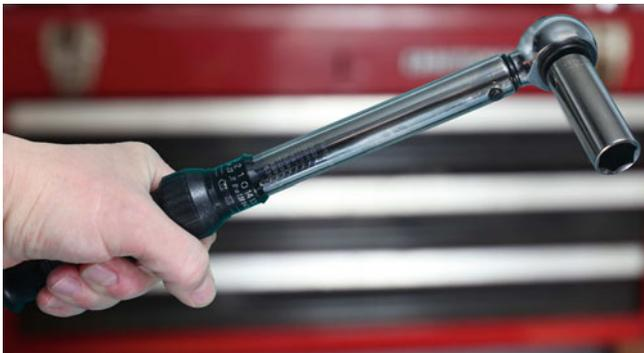
Mit einem Drehmomentschlüssel kann man beim Eindrehen von Rohrverbindungen ein vorgegebenes Drehmoment exakt einhalten und läuft nicht Gefahr, die Verbindung zu überdrehen. (© akatz66 - Fotolia.com.)
