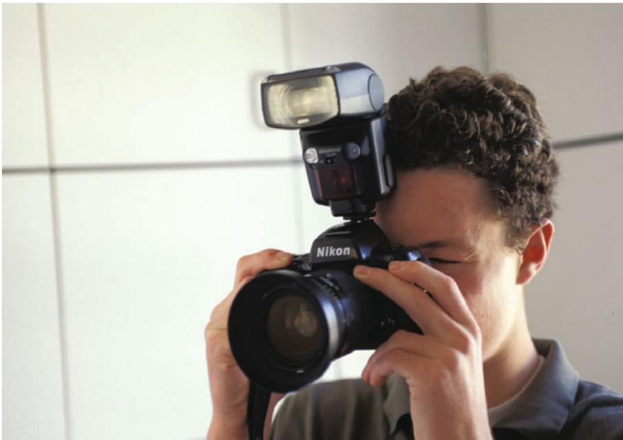
Die Energie für das Fotoblitzlicht dieser Kamera wurde von einer Batterie auf einen Kondensator übertragen.
