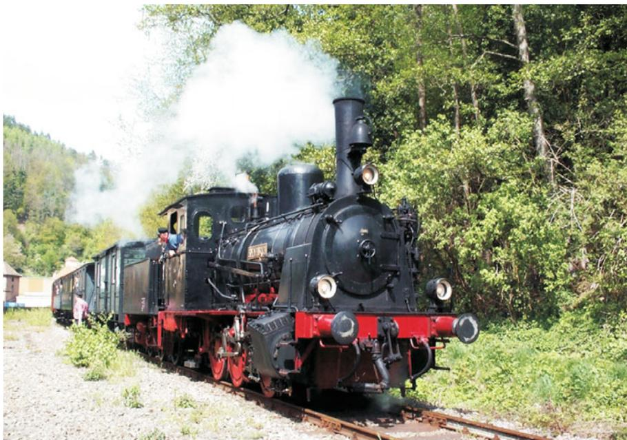
In dieser alten Lokomotive wird Dampf erzeugt, der an einem Kolben Arbeit verrichtet und dadurch den Antrieb bewirkt. Der Wirkungsgrad einer Dampfmaschine erfüllt den zweiten Hauptsatz der Thermodynamik. (© DGEG Eisenbahnmuseum Neustadt-/Weinstraße, Foto: Thomas Kayser.)
