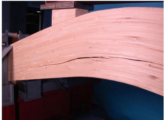
Gebogener Balken, bei dem die Spannung im unteren Teil schon zu einem Riss im Holz führte. (© Johannes Vielhaber.)
