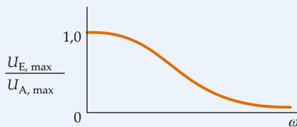
**Abbildung 26.24** Darstellung der Dämpfung von hochfrequenten Signalen, wobei tieffrequente nahezu unverändert durchgelassen werden, daher die Bezeichnung.
