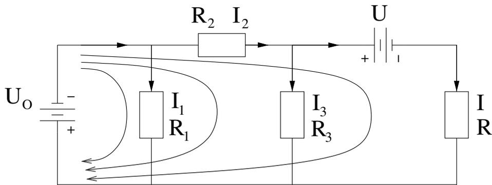
1. Regel: Die Summe der Ströme in einem Knoten ist gleich Null. Die zufließenden Ströme sind *positiv*, die abfließenden Ströme sind *negativ*.
