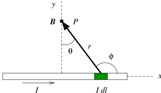
Das Stromelement  $Idl$  erzeugt im Punkt  $P$  ein Magnetfeld mit der Richtung  $Idl \times r$ , es zeigt also aus der Papierebene heraus und ist gleich:
