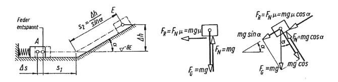
b) Energie am Ende der Bewegung  $E_E$  ist gleich kinetische Energie  $E_A$  minus Verluste durch Reibung:
