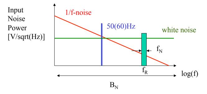
50Hz oder 1/f werden reduziert durch geschicktes Wählen der Referenzfrequenz. Durch weisses Rauschen wird die Messung band-limitiert. Angenommen das Instrument hat eine Bandbreite  $B_N$ =100kHz. Die Rauschbandbreite des Lock-In 's  $f_N$  kann auf 1/1000Hz reduziert werden, d.h. eine Messung dauert etwa 500Sekunden. Das SNR (signal to noise ratio) wird um Faktor  $10^4$  verbessert.
