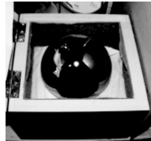
Si-Einkristallkugel auf 8nm genau bearbeitet
